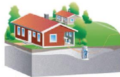
Med Flygt LTA trycks avloppet utan krav på självfall fram till det kommunala avlopps nätet.
