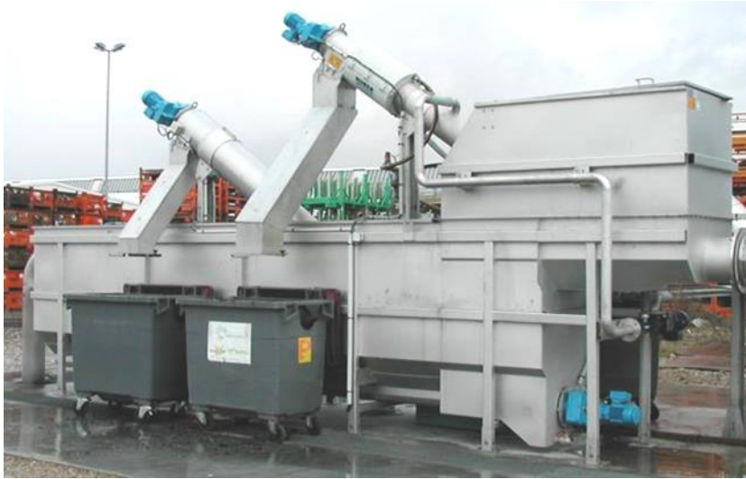
HUBER komplettanlegg ROTAMAT® Ro 5 ( Grovsil, Sand og fettfang)
