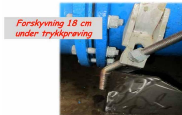
Figur 2. Store krefter virker i vannkummen (Foto: Arve Hansen, VA-teknikk as).
